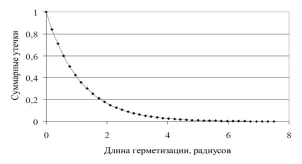
Рис. 2 – Зависимость утечек (подсосов воздуха) от необходимой длины герметизации скважины
