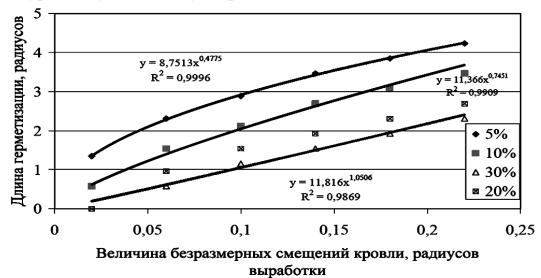
Рис. 3 – Зависимость необходимой длины герметизации от величины смещений кровли и допустимых уровней утечек воздуха: 5%; 10%; 30%.
