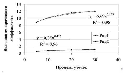
Рис. 4. — Графики для определения эмпирических коэффициентов в зависимости от уровня утечек: верхняя кривая — зависимость коэффициента а), нижняя — коэффициента b) от процента утечки.
