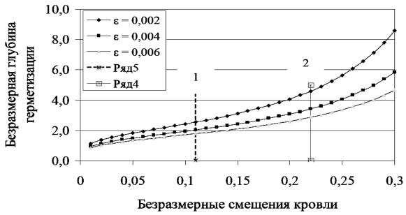
Рис. 1 — Зависимости глубины герметизации дегазационных скважин при допустимых величинах деформации (ε): 0,002; 0,004; 0,006
